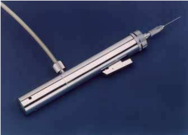
Abb. 4: Das Handstück, mit dem die Injektionen durchgeführt werden.
